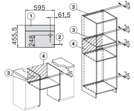
DGC7x40 Anschlüsse und Belüftung 45cm, Skizze
