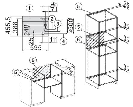
DGC7x45 Anschlüsse und Belüftung 45cm, Skizze
