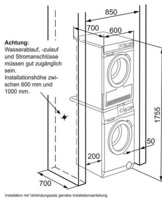
Belüftungsbeispiel für Wasch-Trockensäule, Schrankinbau,
